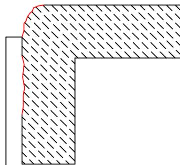
Perdida de capa superficial de Hormigon dejando la armadura a la intemperie, oxidandose y con peligro de perder la resistencia portante
